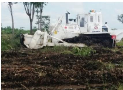
地雷除去機による地雷処理
