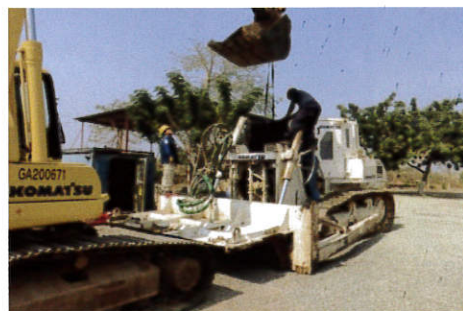
対人地雷除去機整備作業を指導中の専門家
