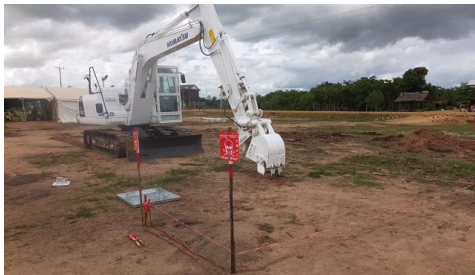
破碎処理をするクラスター弾処理機
