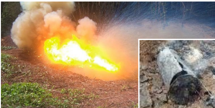
焼却処分(サーマイトによる炸薬燃焼及び焼却後の爆雷)
