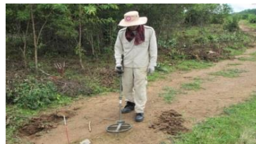
道路の不発弾探査
