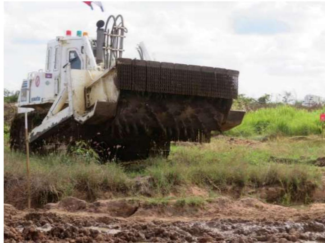
ローターに着いた爪で地雷を時破壊
